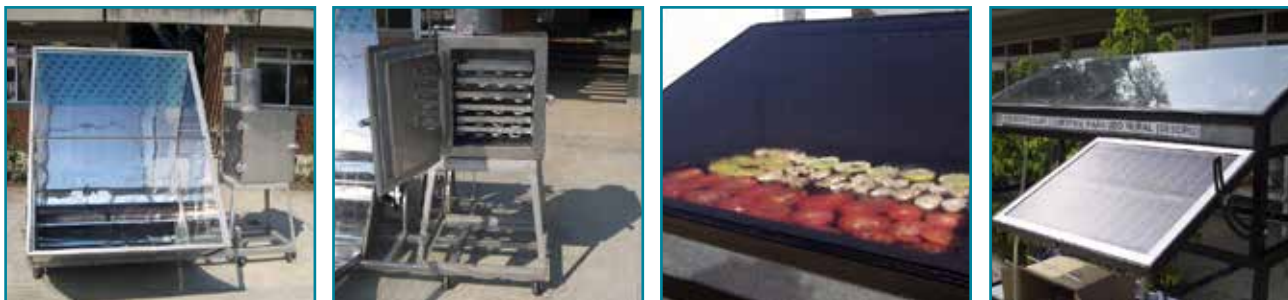
Figura 1. Secador solar y refrigerador solar intermitente. Instituto de Energías Renovables. UNAM. México
